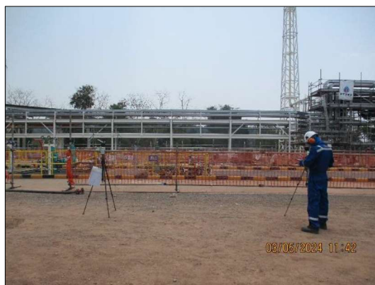
ภาพถ่ายที่ 3.4.7-1 การตรวจวัดระดับเสียงเพื่อจัดทำเส้นเท่าระดับเสียง (Noise Contour Map) บริเวณฐานผลิตเอ
